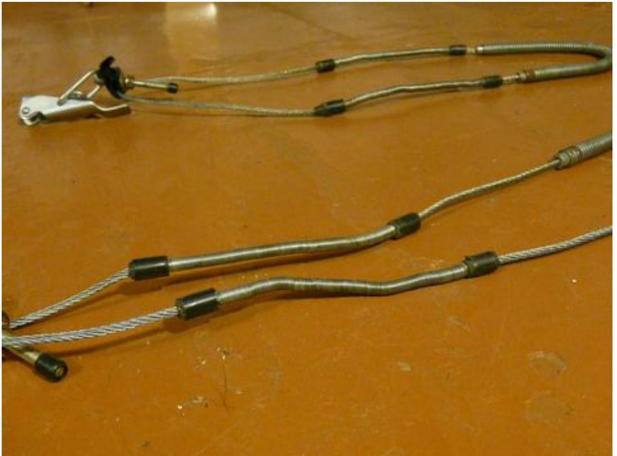
Тросики. Тут всё просто – изоленга на концах защитных пружин, чтобы предотвратить их выскальзывание из креплений на скобе.
