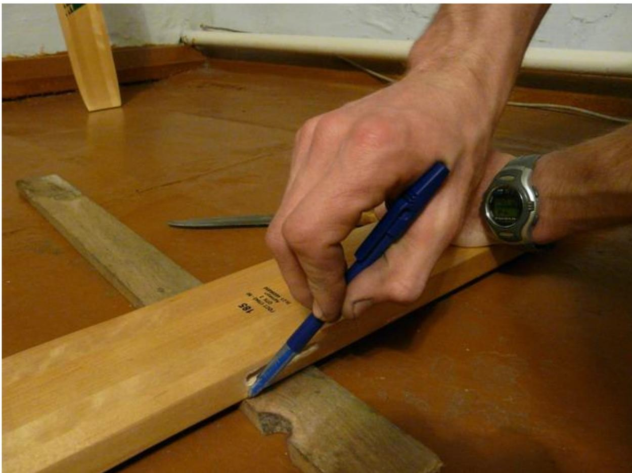
Для того, чтобы это отверстие заделать, понадобятся дощечки соответствующей формы. Отмеряем их длину (она будет равна ширине лыж).
