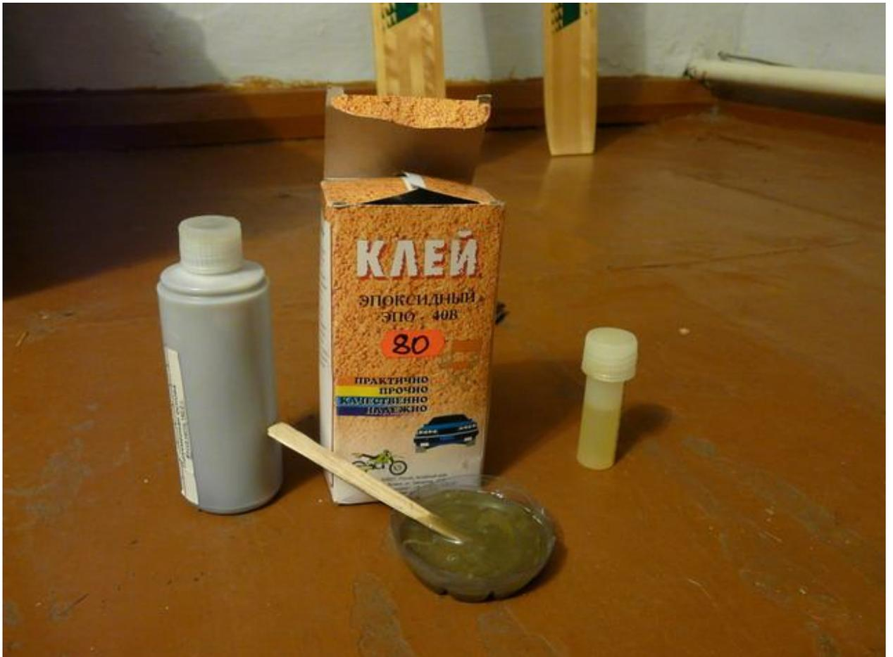
Эпоксидная смола. Разводим небольшое количество согласно инструкции и перемешиваем до состояния однородной массы.
