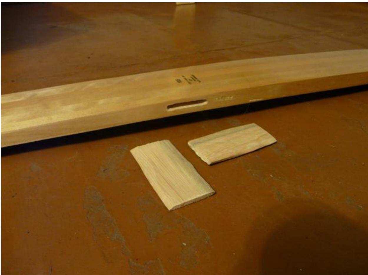
После пиления и строгания получаем два таких деревянных чопика.
