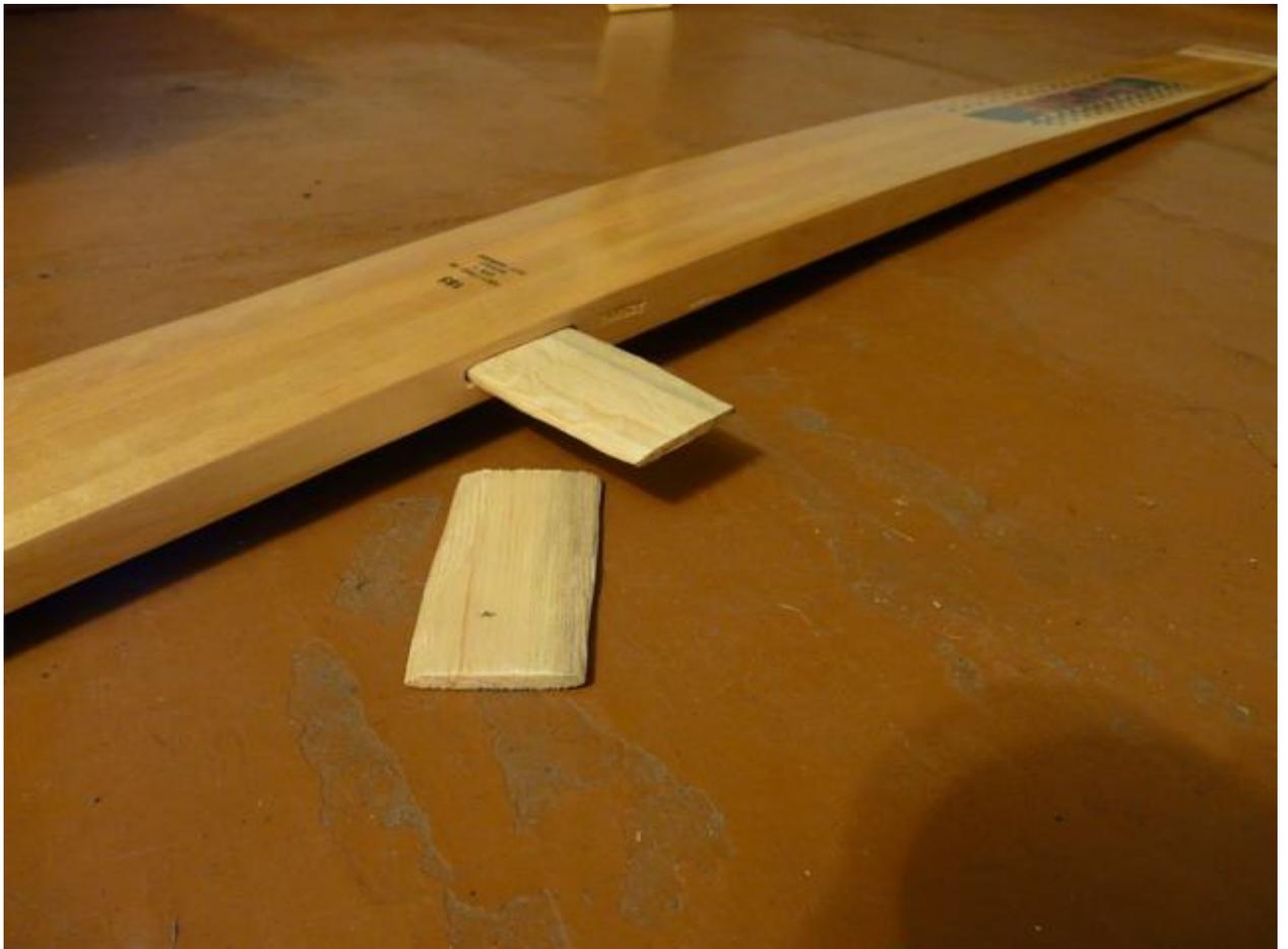
На свои места они должны входить туго, но без помощи молотка, кувалды, топора и прочих инструментов настоящего ювелира. Особые маньяки могут распилить каждый чопик поперёк на две равные части и подгонять их отдельно, ибо отверстие в лыже внутри сужается к середине.
